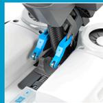
Le support de conduite/parking offre un maintien soutenu et allège la charge sur le timon réduisant ainsi la fatigue de l'opérateur pendant le nettoyage. L'équilibre intégré de l'autolaveuse reste stable même lorsque le timon est incliné G/D. L'i-mop est équipé d'un commutateur d'angle électronique, ce système assure la protection des batteries. Lorsque l'inclinaison du timon dépasse 32°, le moteur se coupe automatiquement pour garantir une utilisation sécurisée et prolonger la durabilité.
